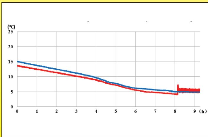
容器内的水温变化，当环境温度是  $-10^{\circ}C$  时，带有一个  $0.05W/cm^2$  ( $150W$ ) 的表面负载。可以看出，容器的内部温度稳定在  $5^{\circ}C$ 。
