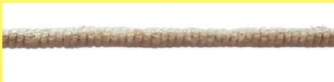
约 1960 年，Calor 发热线，直径 1.7mm，单镍铬发热线，直径 0.08mm，在一个稍微扭成一束的棉芯上以防止弯曲变形。(Ultimheat 收集)
