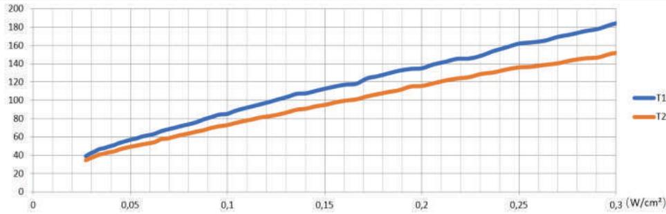
带金属保护编织的发热丝在  $20^{\circ}C$  环境中的表面温度，以  $^{\circ}C$  为单位，用于发热毯或布袋加热器的不同表面瓦特密度值。
