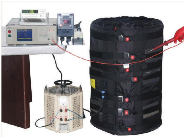
在热条件下总电流泄漏的测量设备
