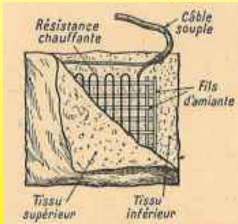
以下关于个人取暖的文章来自1932年的：地毯、拖鞋、毛毯、针织品、夹克等形式加热的织物 ..... 其中耐热性（50瓦）由两根石棉线隔开，在两层织物之间编织（1932年 Boll，向城市和乡村供电）
