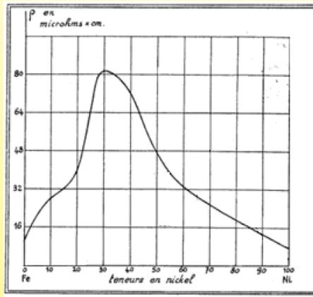
电阻率的变化：铁镍合金中的镍含量曲线图
