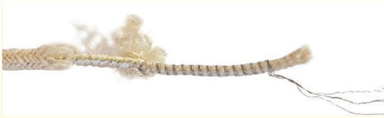
约 1962 年，吉德牌发热线。直接缝在发热毛毯的一面，不再是在两块布之间，在一根棉芯上有 4 个螺旋式镍导体，用非常精细的包装纸覆盖，然后带有一块棉编织物。这个装置是不防水的，而且非常易燃。
