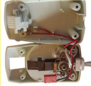
1995年：一种美国功率加热毛毯，类似于库克在1942年发明的，比其早50多年。外部的视图和内部双金属视图有一个带预期电阻的慢断路器。这个型号中唯一值得注意的发展是，它包含了一个噪音过滤器（Ultimheat收集）。
