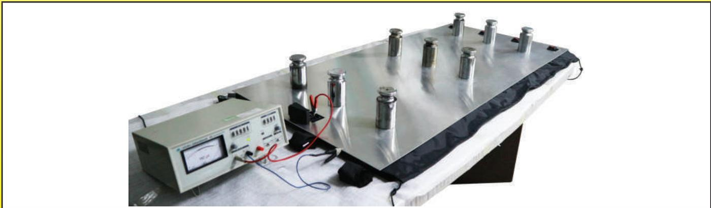
用于测量绝缘电阻的装置。
