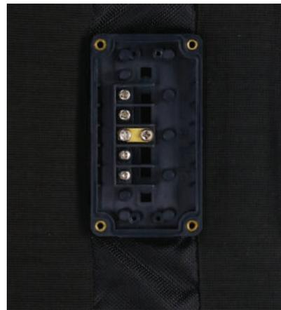
简化的连接盒，用于固定温度的布袋和毛毯加热器。然后通过嵌入在发热丝网中的一个双金属限制器进行表面温度测量。通过两个指示灯显示电源“打开”和加热“打开”。**该控制盒的版本不能与带内置 NTC 传感器的毛毯或布袋加热器的型号互换，用于电子控制。**
