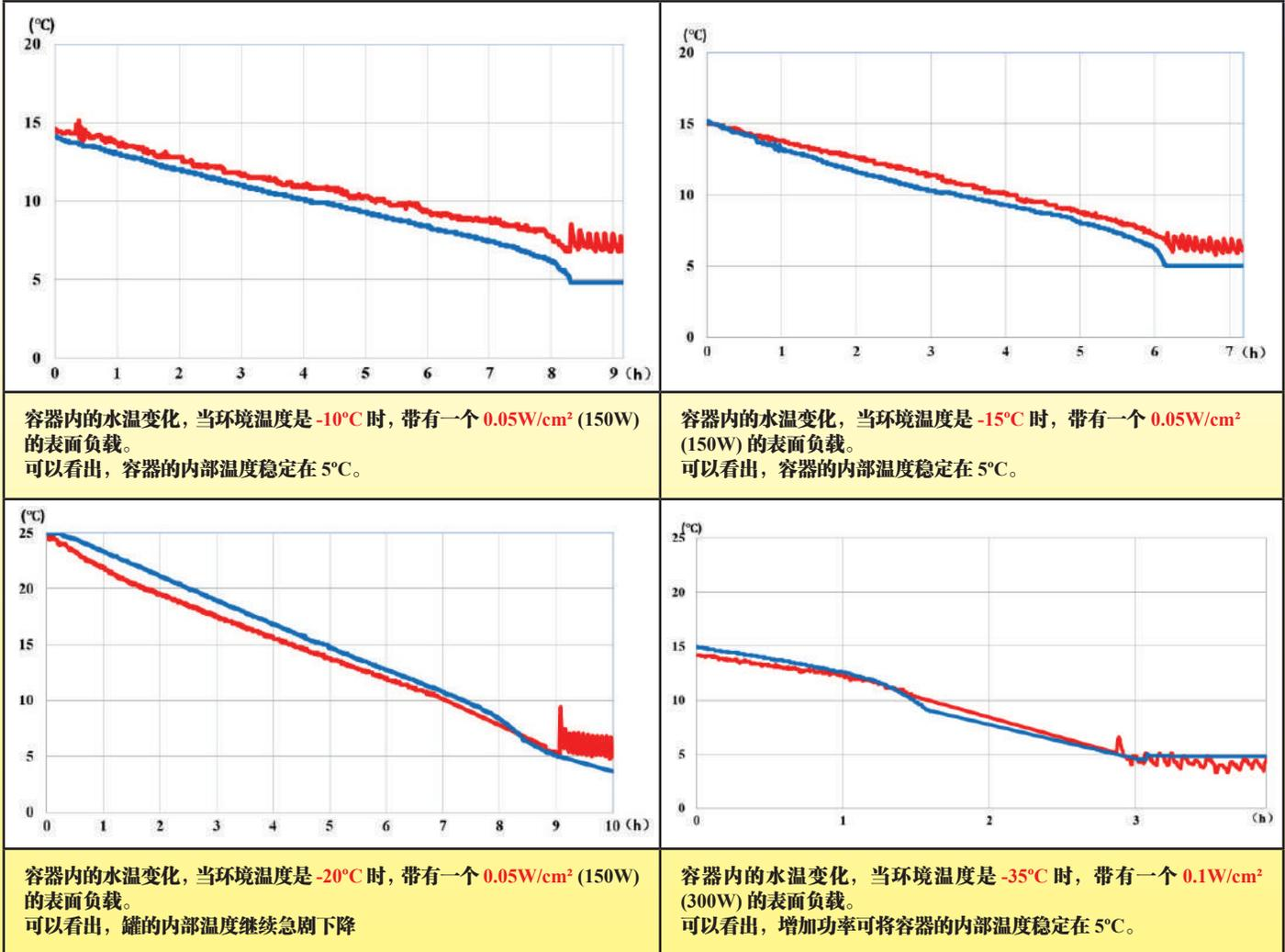
**结果分析:** 在所有的面上均带有一个10mm的绝缘厚度, 0.05W/cm<sup>2</sup>的表面负荷足以防止一个绝缘罐体冻结至-10°C的环境温度。通过将表面负载增加至0.1W/cm<sup>2</sup>, 使保护达-15°C。
