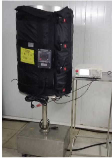
IPx6测试后的绝缘电阻测量
