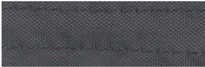
发热电缆在  $120^{\circ}C$  持续 96 小时：没变色，绝缘没熔化，性能没发生变化
