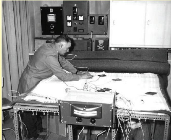
测量加热毛毯的表面温度
