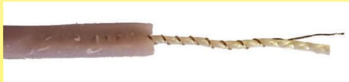
柔韧的，带有一根非常小直径 (2mm) 的 PVC 绝缘发热线，单导体直径 0.11mm 红铜合金 (很可能是镍银)，缠绕在直径 0.5mm 的聚酯芯上，用于通用电气的发热毯 (英国)，约 1962 年。这个装置是非常易燃的。(Ultimheat 收集)
