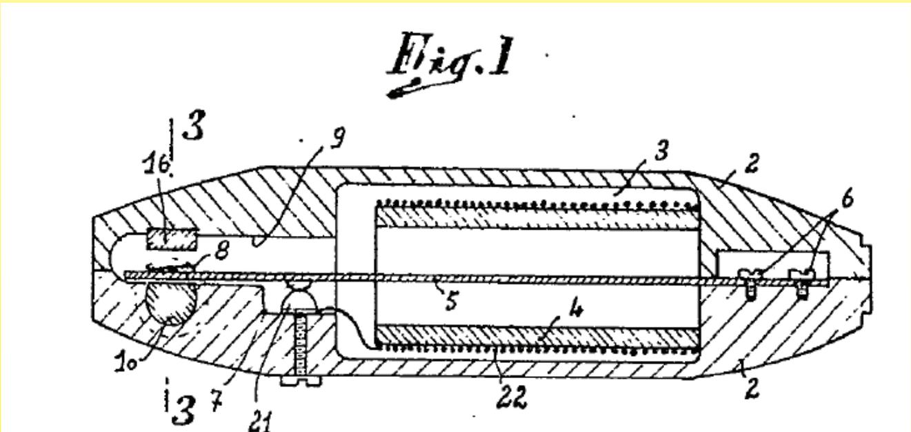
1954 年，在 Tisselec 工作的莫瑞斯·皮尔·马尔为一种双金属开关申请了一项专利。这个产品在加热毯上采用了一个小的串连电阻器 (22 号)，并且缓慢地加热一个双金属条 (5)。本发明的目的是创造一个热定时器，在一定的持续后可自动关闭加热。Marchal 完全未能实现逐步加热控制，尽管他的系统非常接近这个想法。
