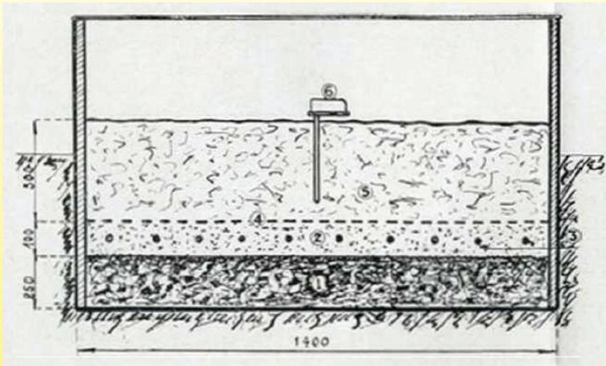
1: 熔渣, 2: 沙, 3: 发热电缆, 4 网格, 5: 盆栽土壤, 6: 温度限制器
