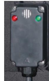
用于 NTC 传感器的电子温控器。带有预期的打开 - 闭合动作，用旋钮进行调节，带有指示灯展示电源开启及加热开启。
