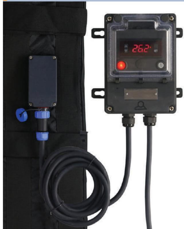
用于 NTC 传感器的电子温控器。打开 - 关闭动作，数字显示。远程墙壁安装。带有长的温度传感探头，用于浸入在液体中。可以在表面温度控制之外使用，以在达到液体的核心温度时结束再加热的过程。**注意：它不能直接用于加热的控制，除非它已经存在有一个表面温度的调节，因其不能代替它。**
