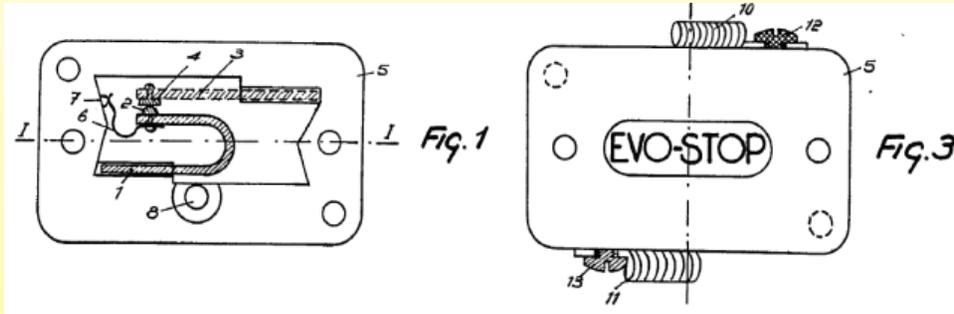
1957 年，Maurice Georges Moïse Gervaiseau，一个热塑性塑料的制造商（勒芒市乔治杜兰大街 151 号），研发了一个简洁的双金属温控器，品牌名为 Evo-Stop，在一个封闭的装置里带有改良的慢断路器，以克服无线电干扰的问题并且专门用于加热毯。（专利 1169253）
